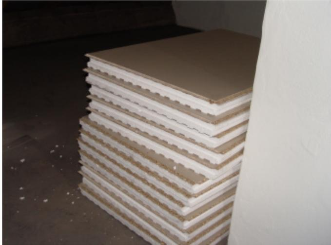
Bild 18: Begehbare Dämmung des Fußbodens im Dachgeschoß des Innovativgebäudes nach der Sanierung.
