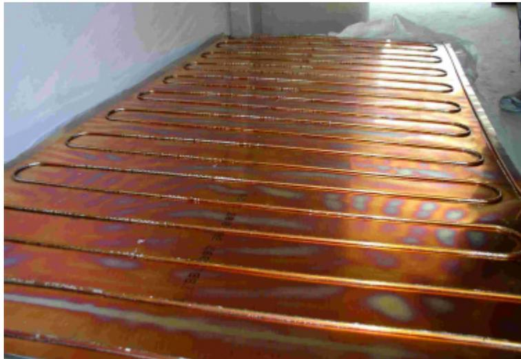
Bild 30: Absorberelement der HTWD.
