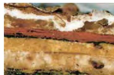
▲ Abb. 5 Querschnitt [QS 2055, 120-fache Vergrößerung] mit den Bohlenwandfassungen.
