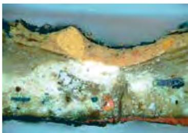
▲ Abb. 5 Querschliff der Farbschichten auf der Holzdecke der oberen Stube in 125-facher Vergrößerung (QS 3370). Deutlich ist der schwarze Anstrich direkt auf Holz erkennbar, darüber roter Ocker, ein ausgemischtes Grau und nochmals ein ausgemischter gelber Ocker (Aufnahme Prof. Schramm).
