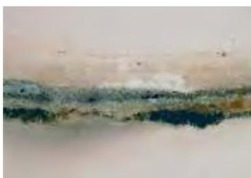
▲ Abb. 4 Querschliff Fassungs Aufbau des Fachwerks in Raum 1.03/1.04, Wand c, der mit den Holzdecken korrespondiert (125-fache Vergrößerung, QS 3372). Dem Schwarz auf Holz folgt hier eine Graufassung. Darüber jüngere, helle Kalktünchenschichten (Aufnahme Prof. Schramm).
