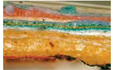
▲ Abb. 20 [Querschliff 2342, 45-fache Vergr.] Probe 02 mit dem Rot einer der Blüten. „... Das untere Rot besteht aus rotem Ocker, partiell begrenzt von Pflanzenschwarz ...“ (Aufnahme Prof. Schramm)
