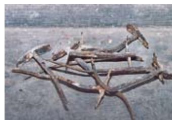
▲ Abb. 19 Mit diesen großköpfigen, handgeschmiedeten („Ochsen“-)Nägeln wurde die Backsteinvorsatzschale vor dem Herabfallen gesichert.
