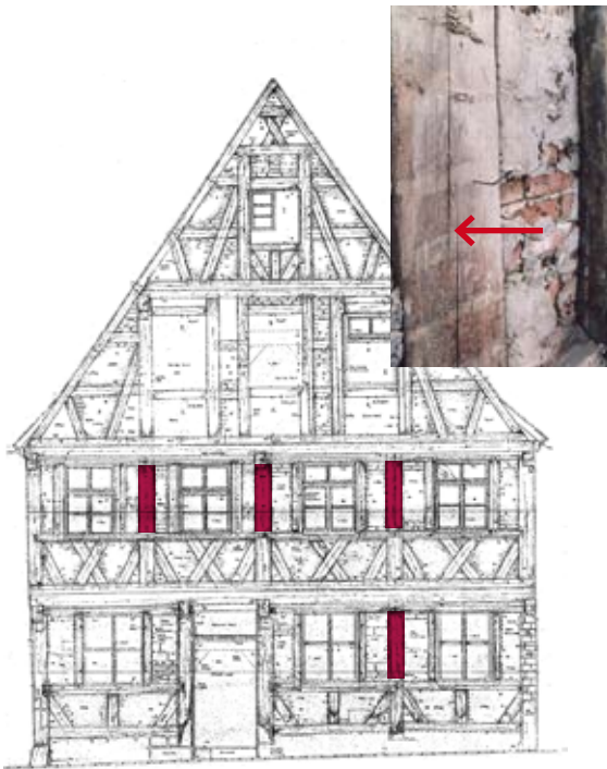
▲ Abb. 13 + 14 Eine weitere Eigenheit des Fachwerks zeigen die durchgehenden Ständer der Erker. Im Brüstungsband mit Andreas-kreuzen waren sie sichtbar (mit Schwarzfassung), über der Brüstung nicht, weil die rohen Außenseiten der Ständer (roter Pfeil) durch das Nischenbrett verdeckt waren (Illustration: Oliver Lindauer, München).
